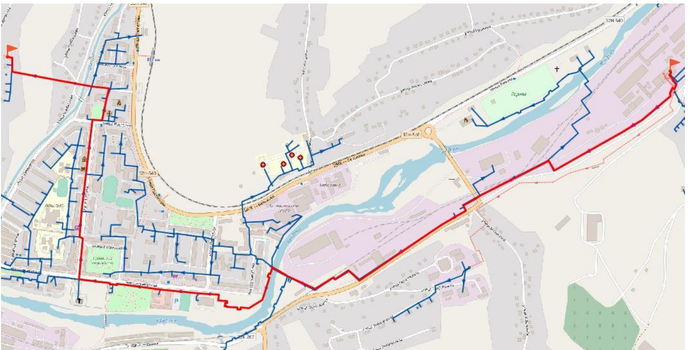
Рис. 9.2. Путь движения теплоносителя от "Производственно-отопительной котельной УПК №1" (новый город) до конечного потребителя – ж/д ул. Романа Артефьева, 26
